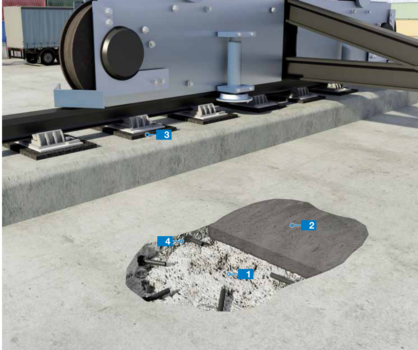
Sanacija betonskih podova i sidrenje tračnica nadzemnih mostnih dizalica
