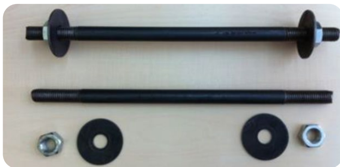
Slika 5. Inercijske mase kao dodatno opterećenje na modelima konstrukcija
